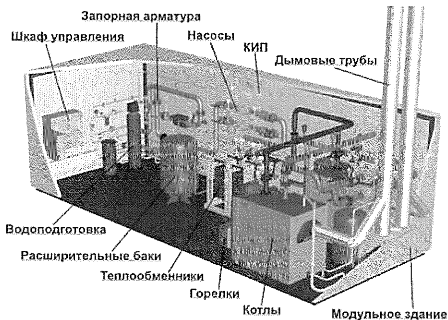
Рис. П. 4.3. Модульная котельная а – общий вид, б – компоновка оборудования
